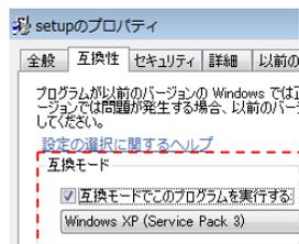
setup.exe を右クリックして「プロパティ(R)」をクリックしてください。左の画面が表示されます。互換性タブを選択し、「互換モードでこのプログラムを実行する」にチェックを入れて、「OK」ボタンをクリックしてください。
